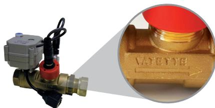
Enhetens inkommande anslutningsända har invändig G3/4 gänga. Utgående anslutningsända har Vatette Dy22 för kopparrör. För anslutning av Vatette-ända:
